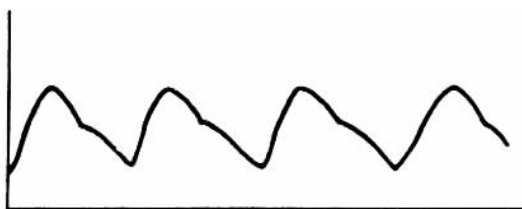
图 17-28 正常动脉压波形
